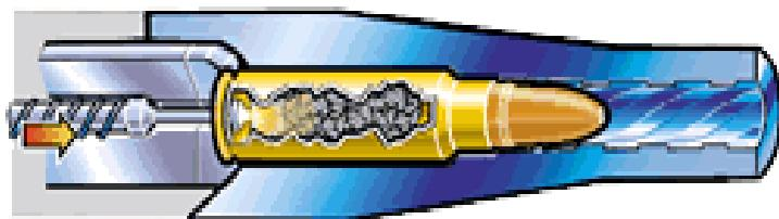
Izgaranjem baruta dolazi do ekspanzije plinova koji potiskuju zrno prema izlazu iz cijevi dajući mu kinetičku energiju koju mjerimo u Julima (J):
