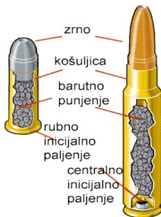
Osnovne komponente su kućište, inicijala kapsila, barutno punjenje, zrno ili za sačmarice zrna i brtveni čep za odvajanje baruta od sačme.
